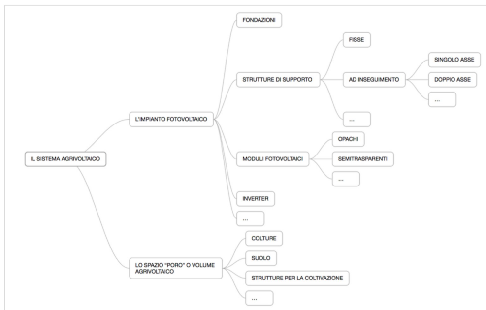
Figura 6 - Le due parti che compongono il sistema agrivoltaico, e cioè il sistema fotovoltaico e lo spazio poro, possono essere scomposte in sottosistemi.
