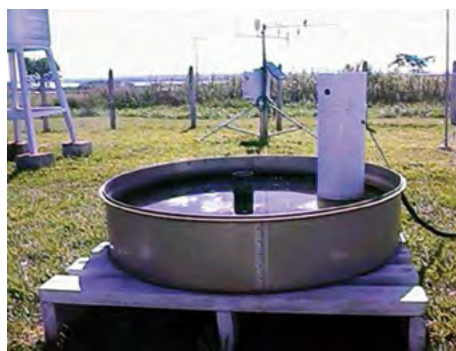
Fig. 17 – Vasca evaporimetrica di Classe A (da www.eltiempodelosaficionados.com )
